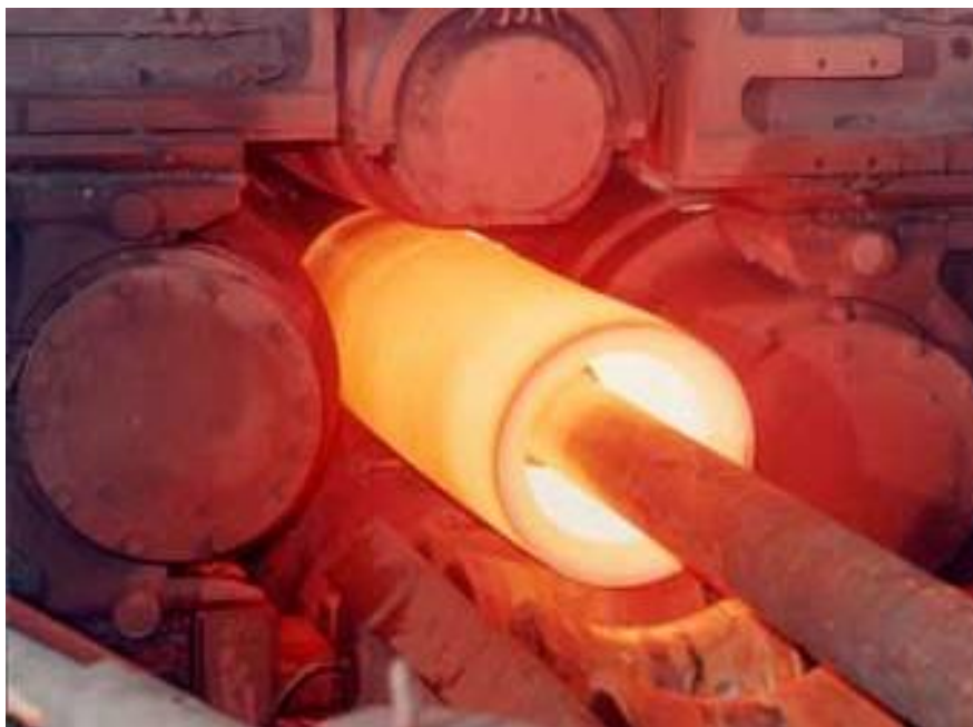
Figura: Processo Mannesmann para tubos sem costura
